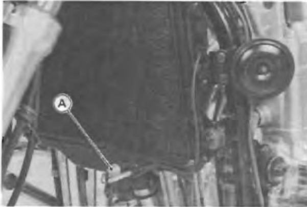
A. Radiator Fan Switch
