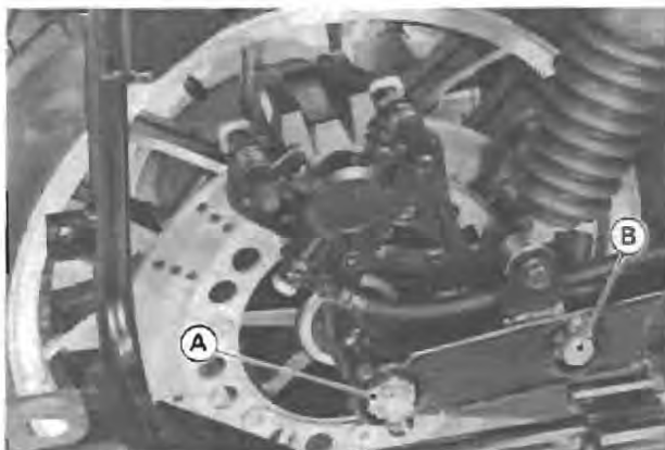
A. Axle Nut B. Caliper Holder Bolt
