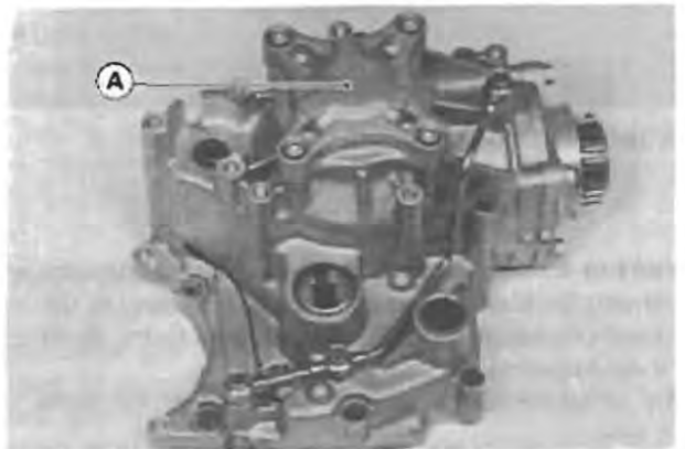
A. Drive Gear Nut Cap
