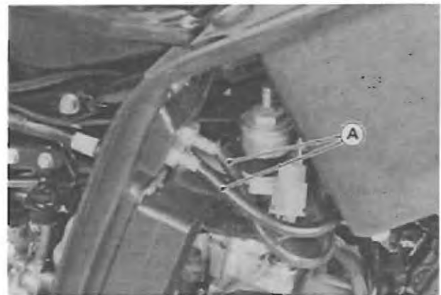
A. Air Hoses
