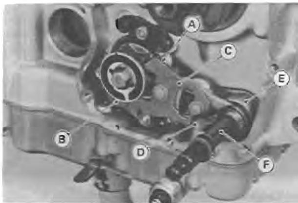
A. Neutral Positioning Lever D. Arm Spring B. Gear Positioning Lever E. Return Spring C. Shift Mechanism Arm F. Shift Shaft
