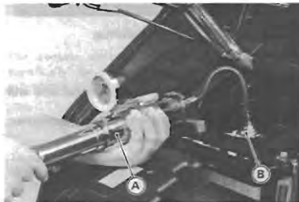
A. Pressure Tester B. Adapter
