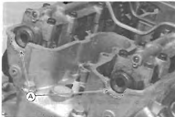
A. Apply silicone sealant.
